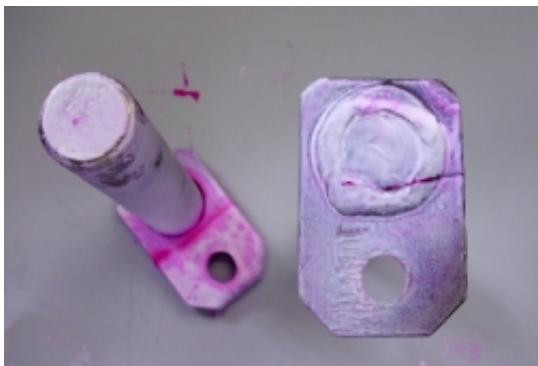
Die Eindringprüfung ist ein zerstörungsfreies Werkstoffprüfverfahren. Es wird angewendet zur Anzeige von feinen Unregelmäßigkeiten, wie beispielsweise Rissen, Poren und Bindefehlern, Überlappungen die zur Oberfläche hin offen sind.
