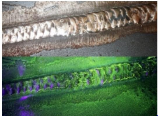
Die Magnetpulverprüfung wird sowohl mit unter UV-Licht fluoreszierenden Prüfmittelsystemen als auch mit tagessichtbaren Prüfsystemen durchgeführt. Eingesetzt wird die Magnetpulverprüfung unter anderem bei der Prüfung von Bolzen, Verbindungselementen, Ringen, Lagerteilen, Schweißnähten, Gussteilen, im Schiffbau, Flugzeugbau, Automobilindustrie, Apparate- und Behälterbau.
