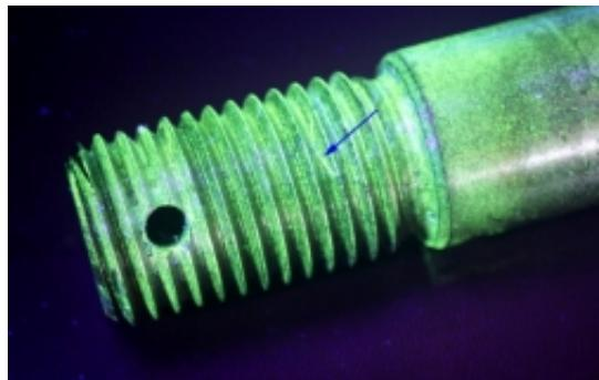
Durch die Anwendung von verschiedenen Magnetisierungstechniken wird den zu prüfenden Bauteilen ein magnetisches Feld aufgezwungen. An den Fehlstellen entsteht eine Konzentration der magnetischen Feldlinien.
