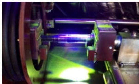
Dieses Verfahren wird am häufigsten angewendet, um an ferromagnetischen Werkstoffen Oberflächenfehler und oberflächennahe Fehler zu ermitteln. Mit diesem Verfahren können Fehler wie zum Beispiel Haarrisse, Risse, Bindefehler und Überlappungen nachgewiesen werden.
