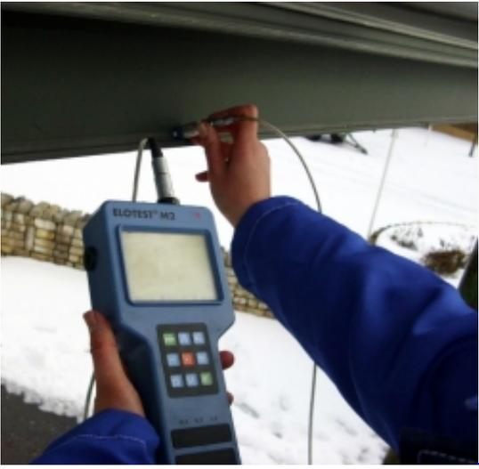
Anwendungsbeispiele für die Maßprüfung sind zum Beispiel die Schichtdickenmessung, Waddickenmessung, Abstandsmessung sowie die Messung von Formabweichungen.
