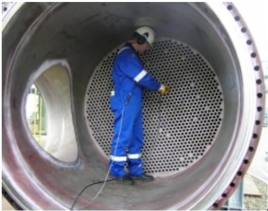
Die Wirbelstromprüfung ist ein elektromagnetisches Verfahren zur Prüfung elektrisch leitfähiger Werkstoffe zur Detektion von Inhomogenitäten die in der Fertigung oder im Betrieb auftreten können.
