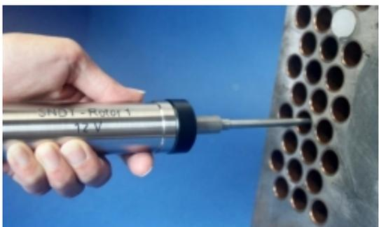
Die Fehlerprüfung ist das größte Anwendungsgebiet der Wirbelstromprüfung. Angewendet wird die Fehlerprüfung zum Beispiel bei der Wärmetauscherprüfung, Rotierprüfung, Fertigungsprüfung von Rohren, Oberflächenrissprüfung, Schweißnahtprüfung usw.
