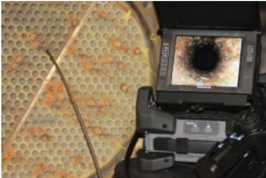
Die visuelle Prüfung oder auch Sichtprüfung ist die grundlegende und älteste zerstörungsfreie Methode für die Feststellung von oberflächenbezogenen Qualitätsmerkmalen. Mit der visuellen Prüfung können verschiedenste Arten von Fehlern gefunden werden, wie z. B. Abweichungen in Form, Farbe und Glanz, mechanische Beschädigungen oder auch große, zur Oberfläche offene Risse.
