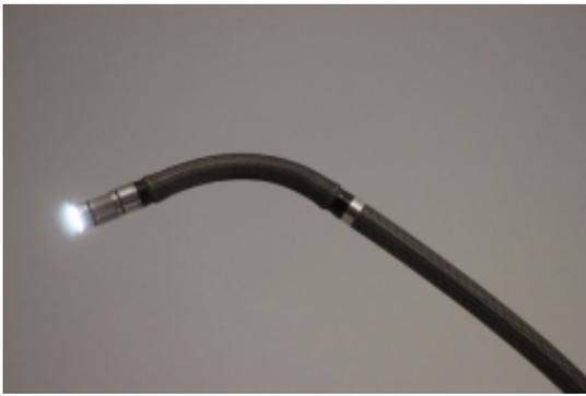
**Unsere nach DIN EN ISO 9712 zertifizierten Prüfer führen die visuelle Prüfung nach allen drei Methoden durch. Für die indirekte Sichtprüfung setzen wir unter anderem ein Videoskop mit 12 m Arbeitslänge und steuerbarem Sondenkopf ein.**
